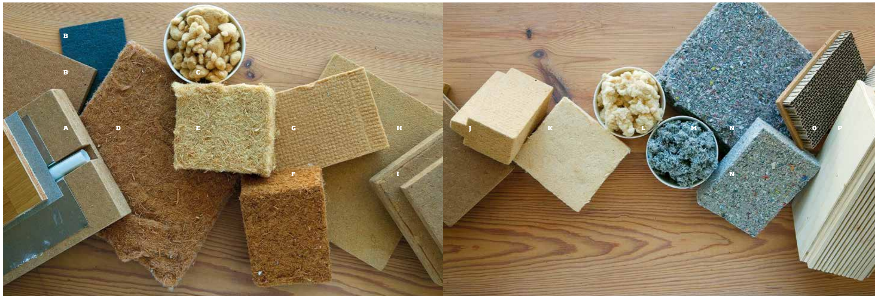
Ovan visar vi ett urval av träbaserade isoleringsmaterial i olika utföranden. Beroende på tjocklek och densitet uppnås olika egenskaper. A. Spårad träfiberskiva för golvvärme. B. Stegljudsisolering. C. Träfiberisolering, lösull. D-G. Träfiberisolering, halvstyv skiva. H. Träfiberskiva (vindbrytare alternativt tilläggsisolering). I. Träfiberskiva, spontad (tilläggsisolering).
