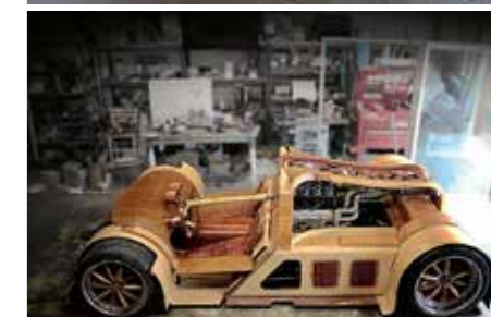
Såväl chassi som ratt och hjul på Joe Harmon's »woodie« är tillverkade av epoxylaminerat trä.
